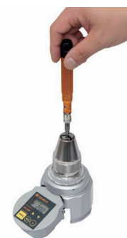
Abbildung einer Drehmomentprüfung der BMRD Drehmomentschraubendreher für kleine Schrauben mit BTGE-G
