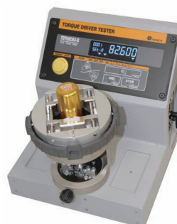
Abbildung einer Kalibrierung der drehmoment Schraubendreher RTD links und FTD rechts mit TDT3-G
