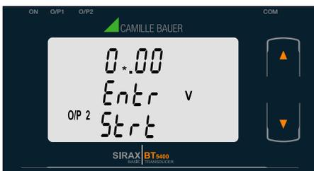
Nachdem die erste Ziffer eingegeben wurde, rufen Sie die zweite Ziffer auf. (\* Zeigt die zweite Ziffer des Startwertes an, dass die Stelle blinkt).
