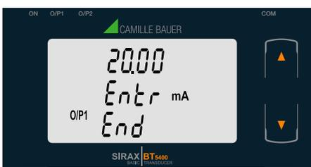
Drücken Sie die "➔ AB" Taste um in den "Neu/ändern Endwert des Ausgangs 1 bearbeiten" Modus zu gelangen.
