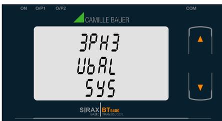
Drücken der “**AB**” Taste führt zum Modus “Systemtyp bearbeiten”. Für Wirk- / Schein- / Blindleistungsmessumformer scrollt der Systemtyp zwischen:
