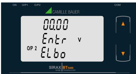
Mit der “**➔ AB**” Taste gelangen Sie in den “Neu/ändern Knickwert des Ausgangs 2 bearbeiten” Modus.
