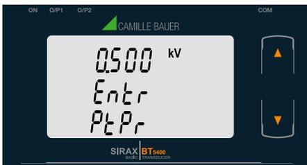
Mit der "➔ AB" Taste gelangen Sie in den "Neu / ändern PT Primärwert bearbeiten" Modus.
