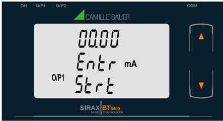
Mit der "
