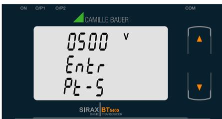
Mit der “**AB**” Taste gelangen Sie in den “Neu / ändern PT Sekundärwert bearbeiten” Modus.
