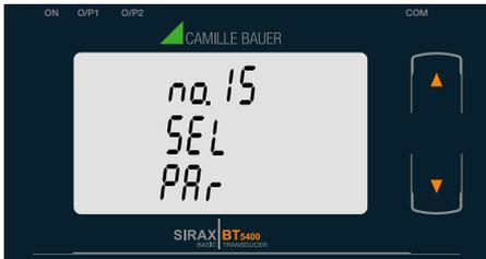
Mit der “**AB**” Taste gelangen Sie zu dem “Parität & Stoppbit bearbeiten” Modus und zeigt folgende Werte:
