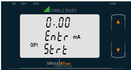
Nachdem die erste Ziffer eingegeben wurde, rufen Sie die zweite Ziffer auf. (\* Zeigt die zweite Ziffer des Startwertes an, die Stelle blinkt).
