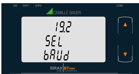
Diese Anzeige erlaubt dem Benutzer die Baud Rate Einstellung des RS 485 Port für dieses Gerät vorzunehmen. Die Werte die auf dem Bildschirm angezeigt werden, sind in kBaud.
