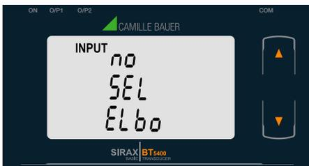
Drücken Sie die “**AB**” Taste um in den “Knick-Funktion bearbeiten” Modus zu gelangen, um den Wert “yes” oder “no” einzustellen.
