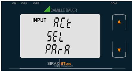
Drücken der “**AB**” Taste führt zum Modus “Messumformertyp bearbeiten” und ermöglicht Scrollen zwischen
