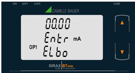
Mit der "➔ AB" Taste gelangen Sie in den "Ausgangs 1 Startwert bearbeiten" Modus.
