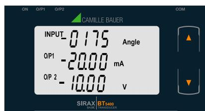
Für Phasenwinkelmessumformer: Eingang Phasenwinkel Ausgang 1 als Strom oder Spannung und Ausgang 2 als Strom oder Spannung.
