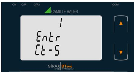
Mit der “**AB**” Taste gelangen Sie in den “Neu / ändern CT Sekundärwert bearbeiten” Modus.
