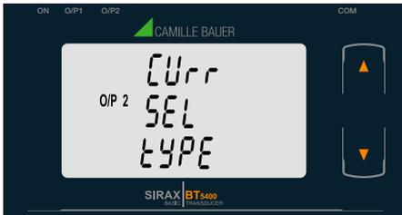
Mit der "➔ AB" Taste gelangen Sie in den "Messausgang 2 Auswahl bearbeiten" Modus und können wechseln zwischen Spannung (Volt) und Strom (CURr).
