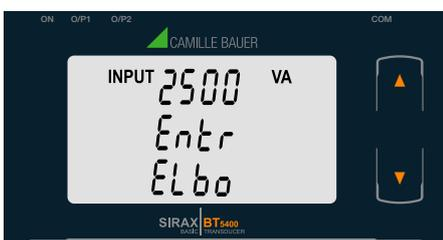
Mit der “**AB**” Taste gelangen Sie in den “Neu/ändern Knickwert des Eingangs bearbeiten” Modus.
