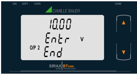
Drücken Sie die "➡ AB" Taste um in den "Neu/ändern Endwert des Ausgangs 2 bearbeiten" Modus zu gelangen.
