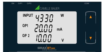
Für Wirkleistungsmessumformer: Eingang Wirkleistung, Ausgang 1 als Strom oder Spannung Ausgang 2 als Strom oder Spannung.
