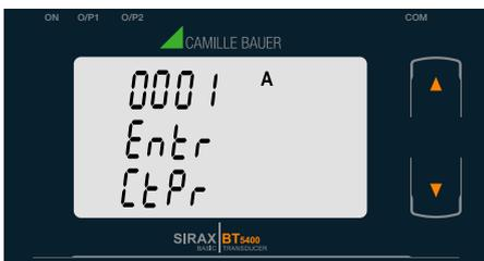
Mit der "➔ AB" Taste gelangen Sie in den "Neu / ändern CT Primärwert bearbeiten" Modus.
