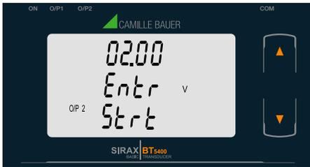
Mit der "➡ AB" Taste gelangen Sie in den "Neu/ändern Startwert des Ausgangs 2 bearbeiten" Modus.
