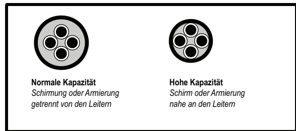
Bild 4-3 Einfluss der Kabelkonstruktion auf die Kapazität
