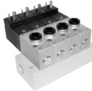
3/2-Wege Magnetventil mit pneumatischer Federrückstellung zur Montage auf Grundplatten. Der Anschluss 2 befindet sich im Ventil.
