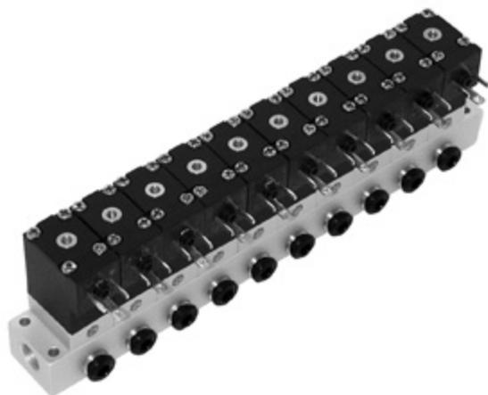
System besteht aus direkt gesteuerten 3/2-Wege Magnetventilen mit mechanischer Federrückstellung, normal geschlossen (n.c.) und dazu passenden Grundplatten für eine gemeinsame Druckluftversorgung (Anschluss 1). Anschluss 2 (Arbeitsanschluss) befindet sich ebenfalls in der Grundplatte. Anschluss 3 an der Magnetspule oben. Nach Verschließen von Anschluss 3 kann das Ventil als 2/2-Wege verwendet werden.
