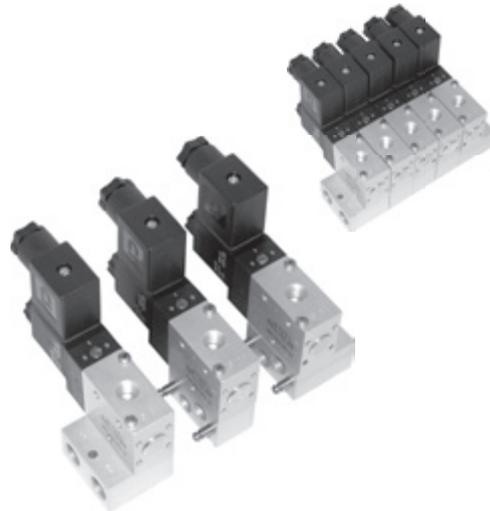
Modulares Grundplattensystem mit gemeinsamen Anschlüssen 1 (Druckversorgung) sowie 3 (Entlüftung). Die Grundplatten werden aus Einzelelementen zusammen gesteckt, fixiert werden sie durch 2 Gewindestifte. Die Endstücke sind mit Bohrungen ausgestattet, die die Montage von DIN-Clips erlauben.
