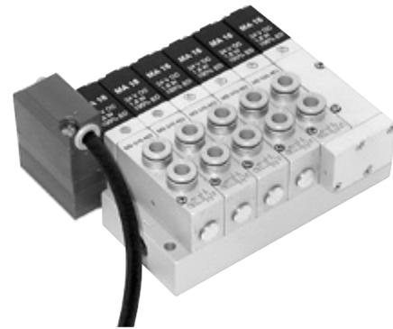
Ventilinsel mit 5-Wegeventilen, Nennweite 4 mm, Anschluss 2 und 4 im Ventil, entweder als 6 mm Steckpatrone oder mit G 1/8" Gewindeanschluss.
