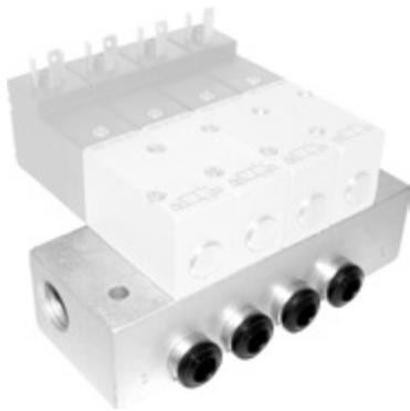
Grundplatte mit gemeinsamen Anschlüssen 1 (Druckversorgung) sowie 3 (Entlüftung). Arbeitsanschlüsse (2) mit Steckpatronen befinden sich ebenfalls in der Platte.
