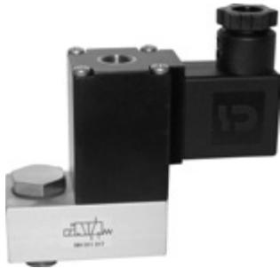
Direkt gesteuertes 3/2-Wege Magnetventil normal geschlossen mit mechanischer Federrückstellung. Anschluss 2 ist als Hohlschraube gestaltet. Nennweite 3 mm, Maximaldruck 7 bar.
