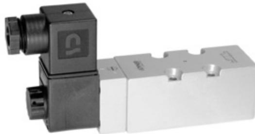
Monostabiles 5/2-Wege Magnetventil mit pneumatischer Federrückstellung. Alle Anschlüsse sind in der Grundplatte.
