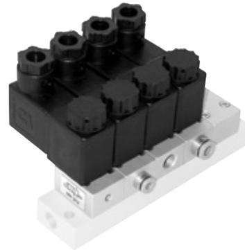
System besteht aus direkt gesteuerten 3/2-Wege Magnetventilen mit mechanischer Federrückstellung und dazu passenden Grundplatten für eine gemeinsame Druckluftversorgung (Anschluss 1). Anschluss 2 (Arbeitsanschluss) und Anschluss 3 befinden sich im Ventil. Nach Verschließen von Anschluss 3 kann das Ventil als 2/2-Wege verwendet werden.
