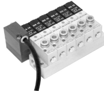
Ventilinsel mit 3/2-Wegeventilen, Nennweite 4 mm, Anschluss 2 im Ventil, entweder als 6 mm Steckpatrone oder mit G 1/8" Gewindeanschluss.
