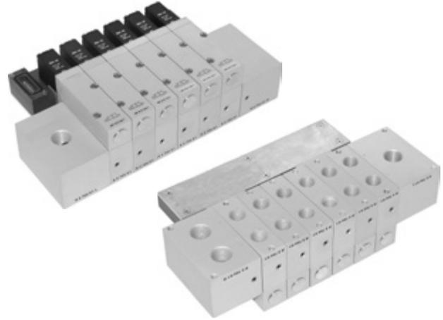
Ventilinsel mit 5-Wegeventilen, Nennweite 7 mm, alle Anschlüsse sind in der Platte. Arbeitsanschlüsse (2 und 4) befinden sich gegenüber der Ventile. Grundplatte insbesondere zur Montage in einem Schaltschrank. Die Verwendung dieser Grundplatte bietet ein signifikantes Einsparpotential an Verrohrungsmaterial.
