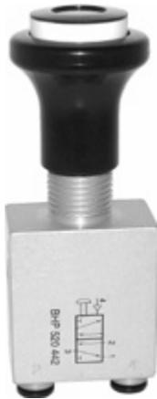
Manuell betätigtes 5/2-Wege Kolbenschieberventil, bistabil mit einer pneumatischen Rückstellfunktion für Schalttafelmontage.
