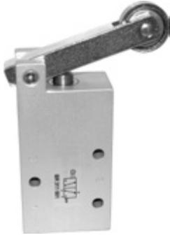
Mechanisch betätigtes 5/2-Wege Kolbenschieberventil mit mechanischer Federrückstellung. Die Anschlüsse befinden sich an den Flanken des Ventils.
