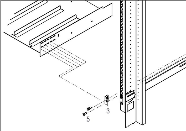
Fixez les écrous-cages (4) sur le châssis de montage.
