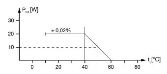
Der Lastminderungskurve ist die max. Belastbarkeit bei verschiedenen Umgebungstemperaturen in Abhängigkeit des Erwärmungsfehlers durch die Belastung zu entnehmen.
